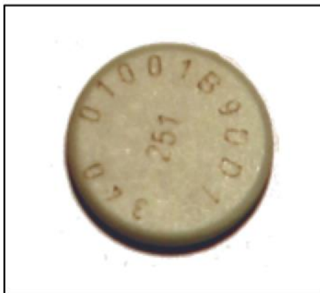
Figura 22 – Primeira etiqueta utilizada pela empresa compatível com a frequência HF ( High Frequency )
