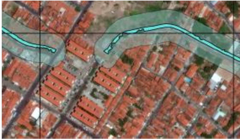
Figura 9 – Ausência do Curso Natural do Corpo Hídrico Devido a Urbanização 1
