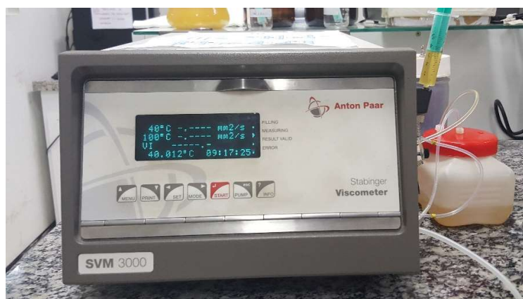
Figura 7 – Viscodensímetro SVM 3000 Anton-Paar.
