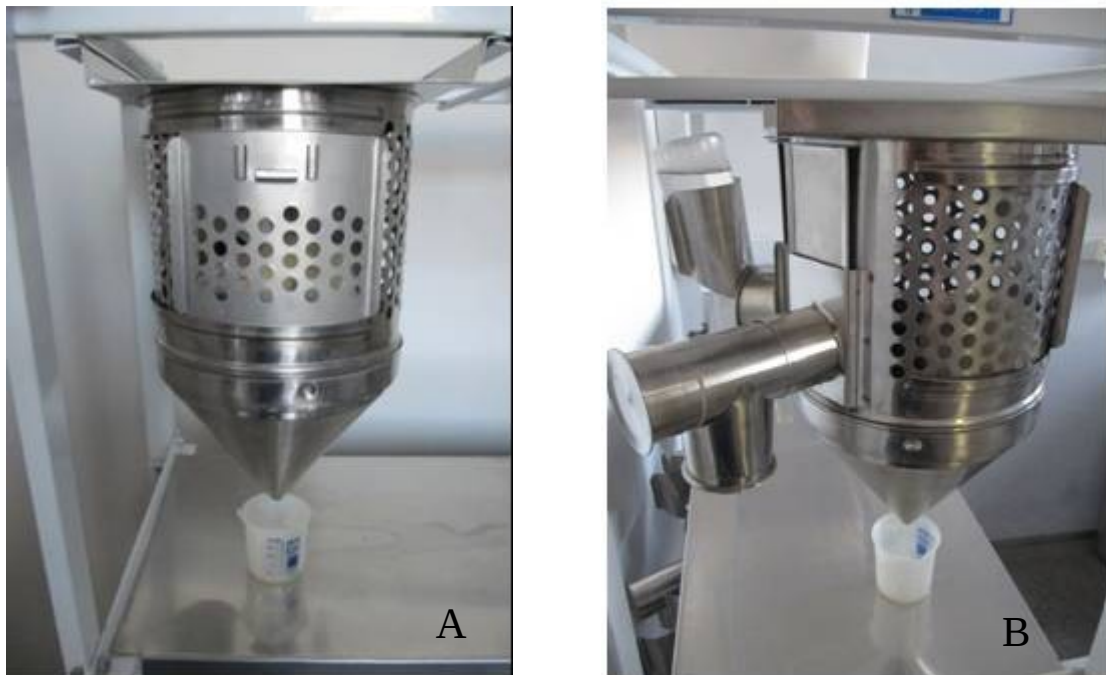
Figura 5 - Fotografias da gaiola metabólica vista anterior (A) e lateral (B)
