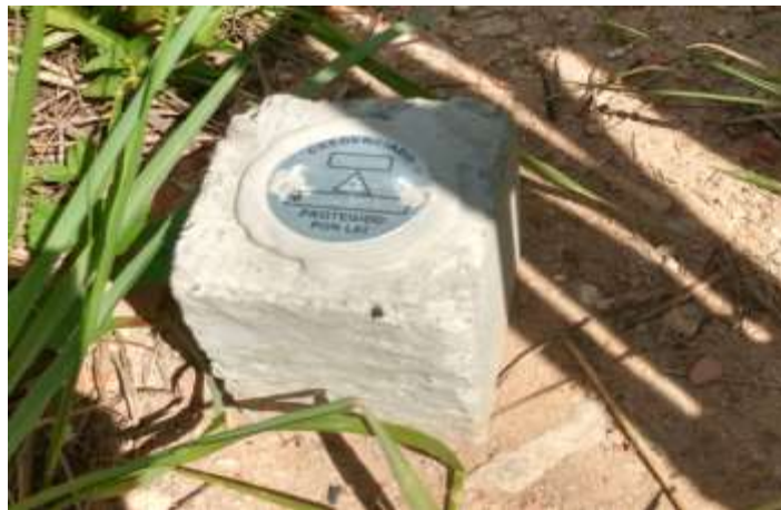
Figura 8 - Marco de concreto com plaqueta de identificação.
