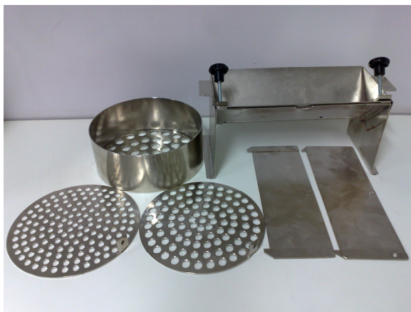
Figura 4.8 - Equipamentos usados para obtenção do índice de forma.
