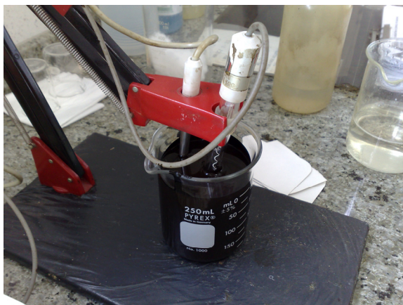
Figura 4.21 - Procedimento para obtenção do pH das emulsões.
