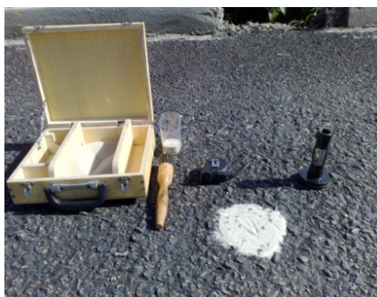
Figura 4.37 - Equipamentos utilizados no ensaio de Mancha de Areia.
