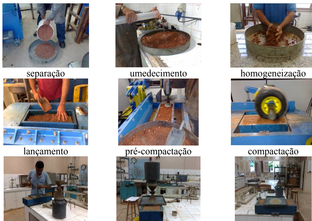
Figura 4.33 - Procedimentos para a moldagem das placas e densidade “in situ”.
