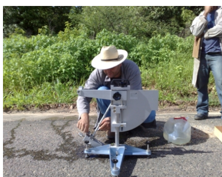
Figura 4.36 - Pêndulo Britânico sendo operado no trecho.
