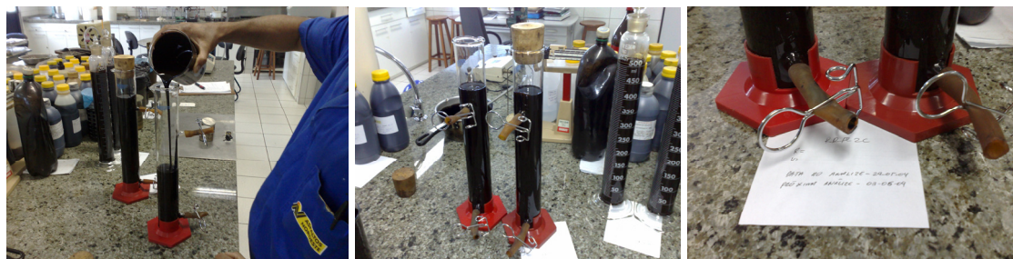
Figura 4.18 - Procedimentos usados no ensaio de sedimentação.
