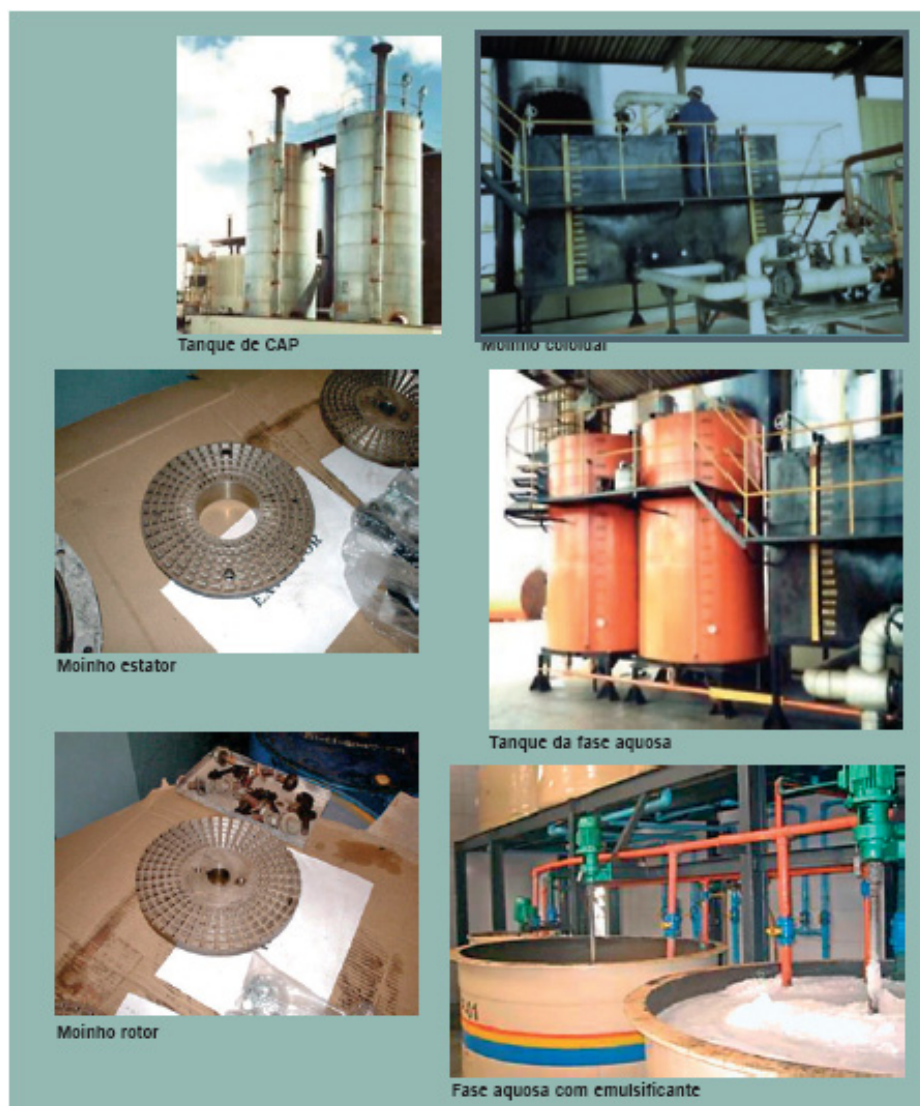
Figura 3.10 - Instalações de uma fábrica de emulsão (BERNUCCI et al., 2007).
