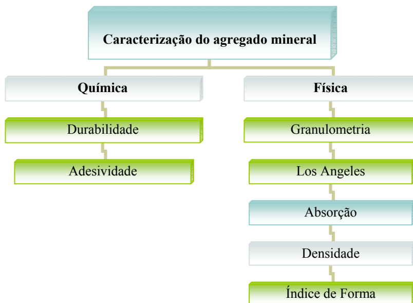
Figura 4.5 - Fluxograma dos ensaios realizados para caracterização do agregado mineral.
