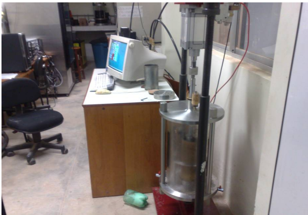
Figura 5.18 - Prensa triaxial de carga repetida e computador do LMP/UFC.
