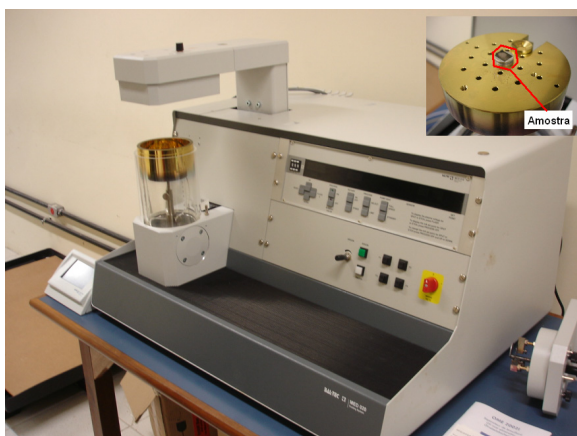
Figura 4.15 - Equipamento utilizado para o recobrimento da amostra com ouro (metalização).
