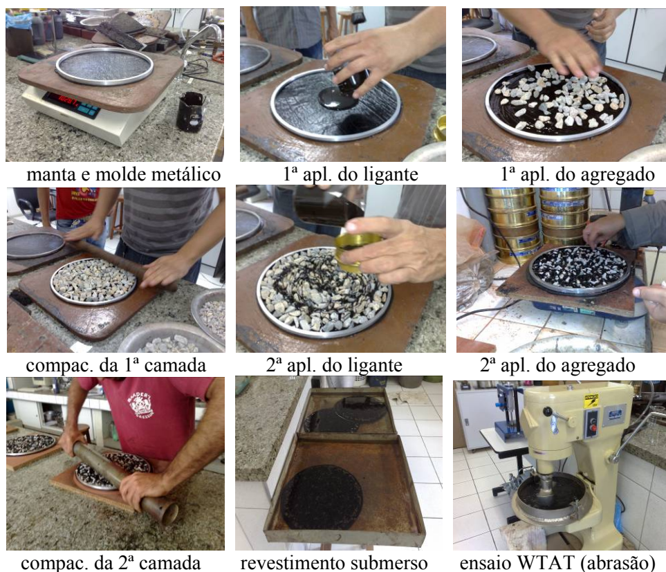
Figura 4.28 - Procedimentos usados para execução do TSD.
