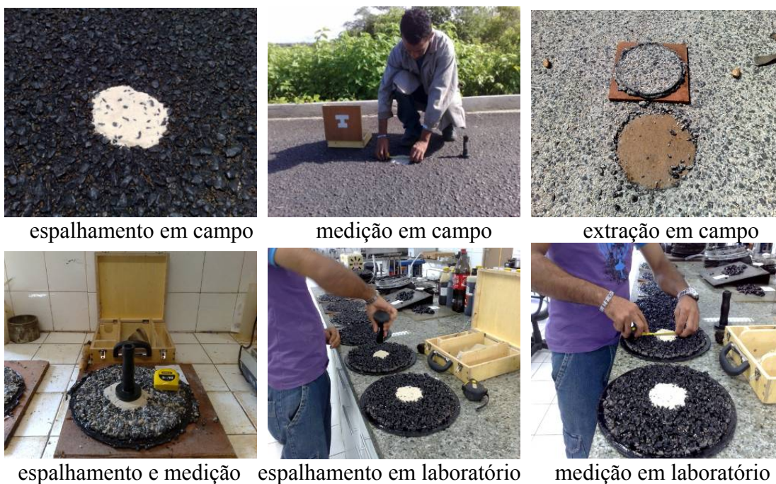
Figura 4.38 - Procedimentos do ensaio mancha de areia, em campo e laboratório.
