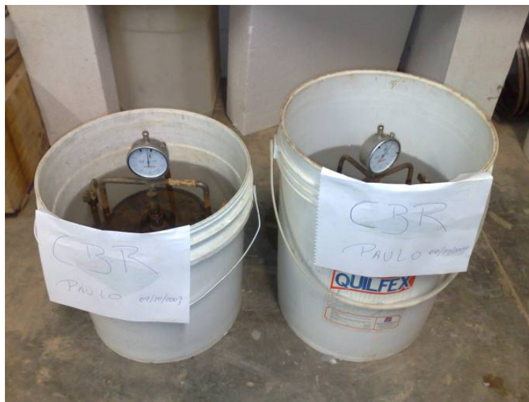
Figura 5.16 - Corpos de prova submersos para realização do ensaio de CBR.
