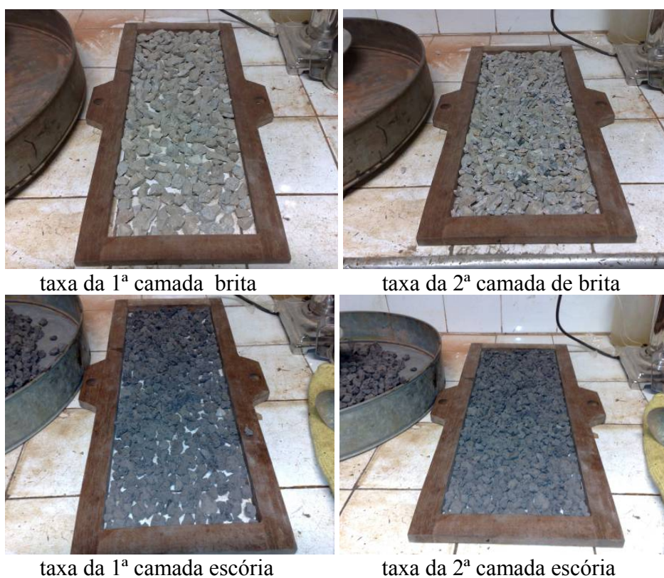
Figura 4.34 - Método usado para definição das taxas dos agregados.
