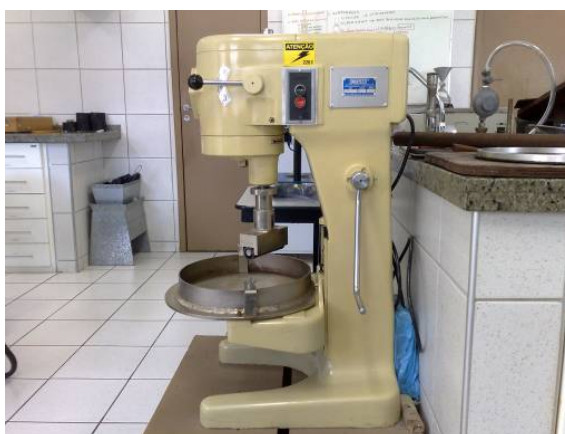
Figura 4.27 - Equipamento utilizado no ensaio WTAT.
