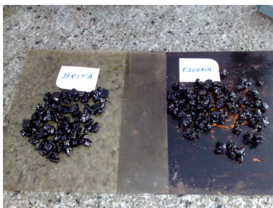
Figura 4.11 - Ensaio de adesividade da brita e escória.
