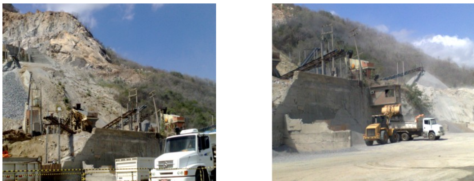
Figura 4.3 - Exploração da pedreira, britagem e transporte do agregado.
