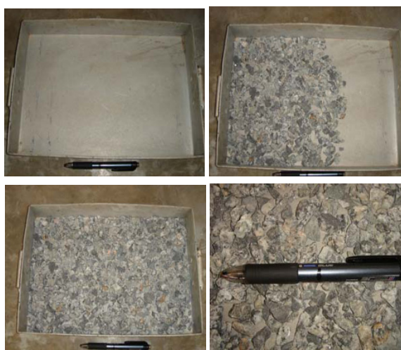
Figura 2.12 - Ilustração do método da bandeja para determinação da taxa de agregado.
