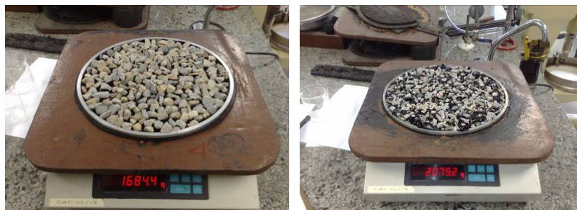
Figura 4.26 - Procedimentos para obtenção das taxas dos agregados.
