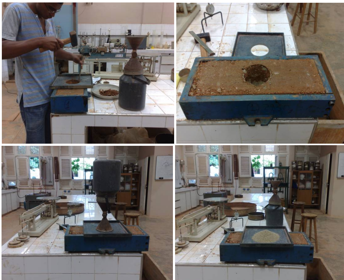
Figura 5.21 - Sequência de operações usadas no ensaio de densidade “in situ”.
