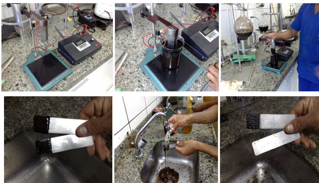
Figura 4.19 - Equipamento e procedimentos para o ensaio carga da partícula.
