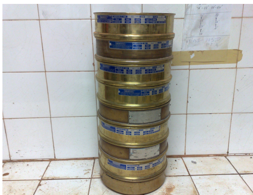
Figura 4.10 - Série de peneiras utilizadas no ensaio de granulometria.
