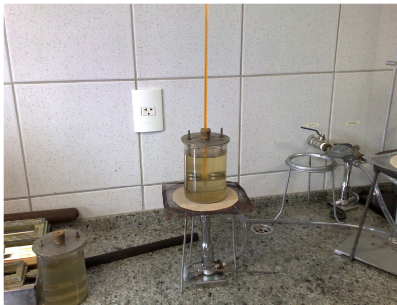
Figura 4.24 - Ensaio para determinar o ponto de amolecimento.
