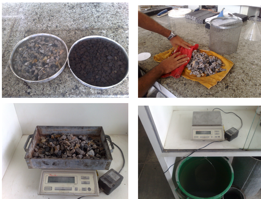
Figura 4.9 - Procedimentos para obtenção da absorção da água na brita e escória.
