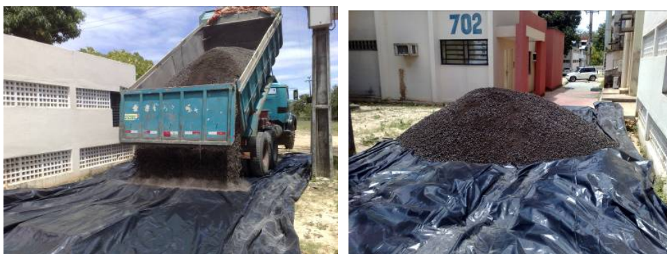
Figura 5.6 - Estocagem e início do processo de cura da escória.
