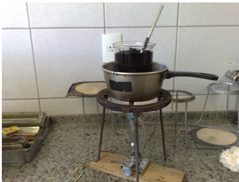
Figura 4.20 - Ensaio de resíduo por evaporação.
