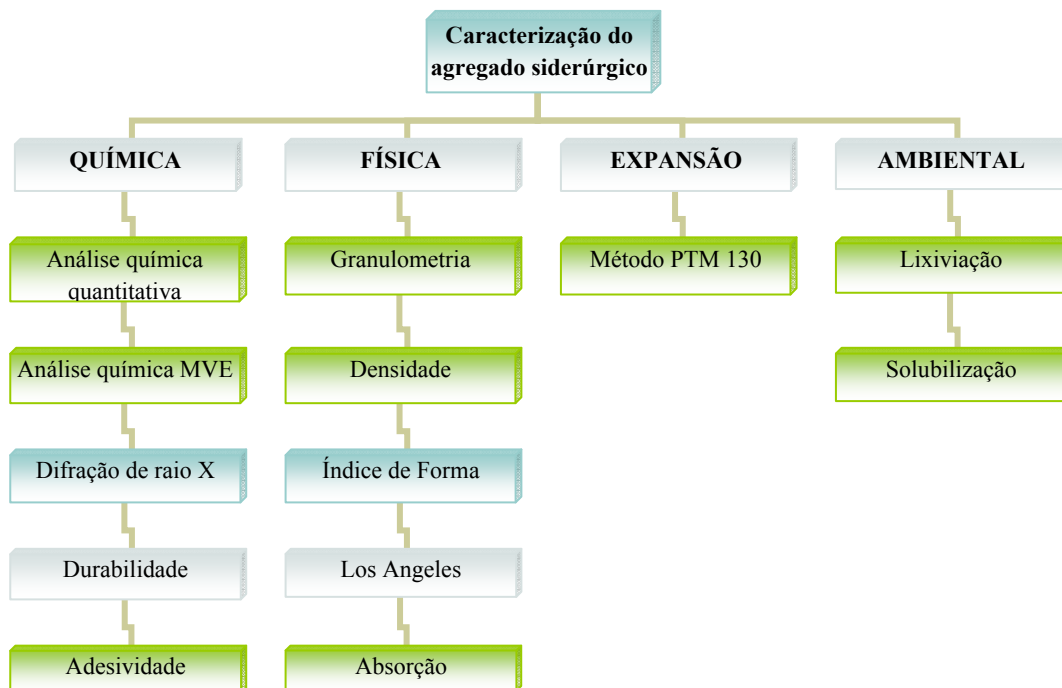
Figura 4.6 - Fluxograma dos ensaios para caracterização do agregado siderúrgico.
