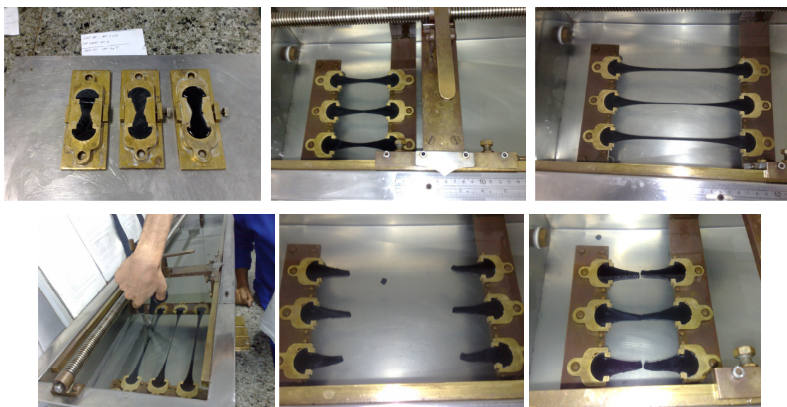
Figura 4.23 - Procedimentos do ensaio para determinação da recuperação elástica.
