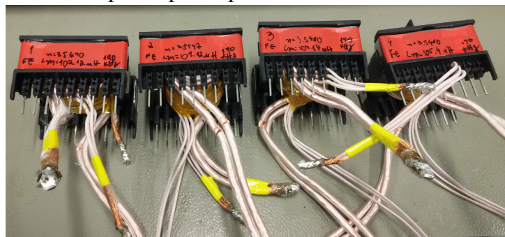
Figura 61 – Os quatro dos seis transformadores construídos para o protótipo.
