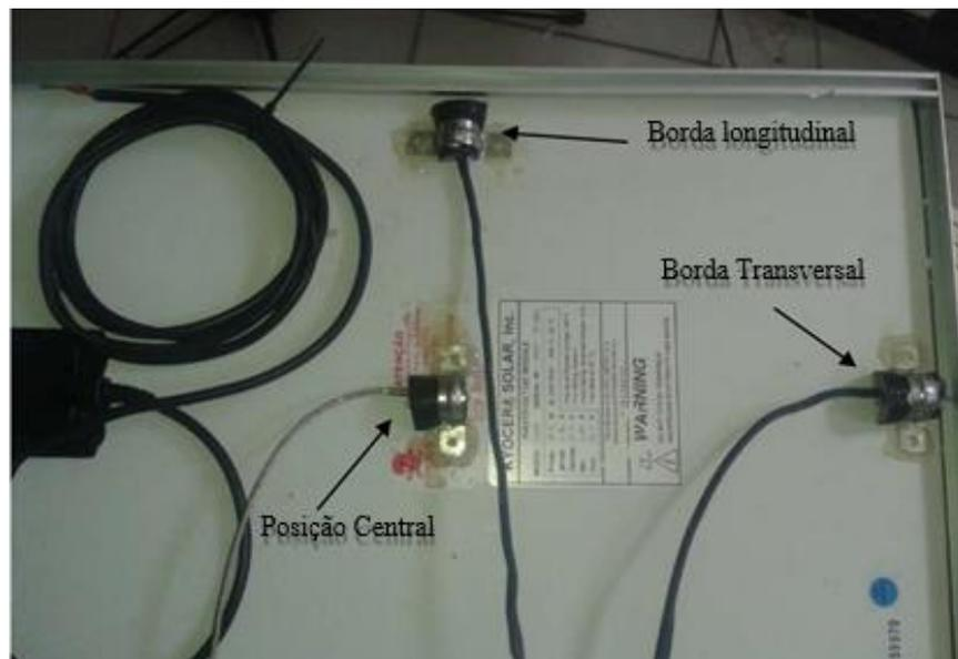
Figura 22 - Sensor PT-100 após a aplicação de silicone
