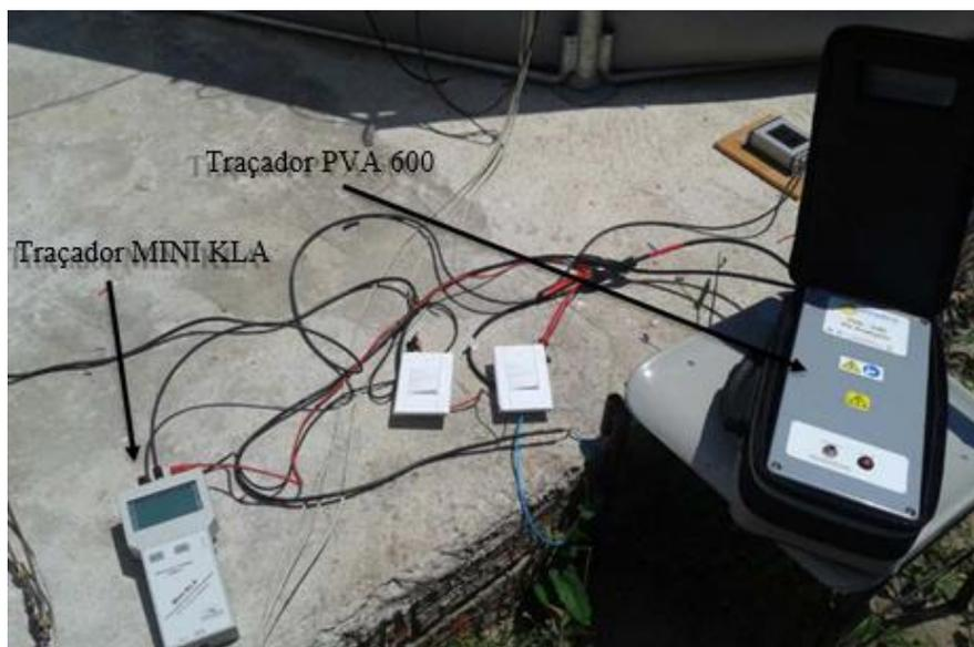
As figuras 25, 26 e 27 mostram, respectivamente, a moldura instalada num módulo FV, o experimento em curso e a verificação de funcionamento do traçador MINI KLA.
