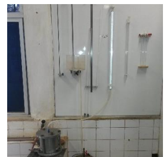
(i) Início do ensaio de permeabilidade.
