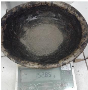
(a) Pesagem do solo seco.
