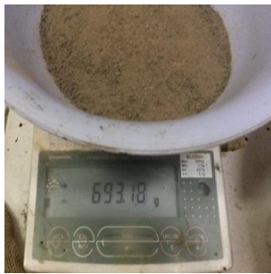
(a) Pesagem do solo seco.
