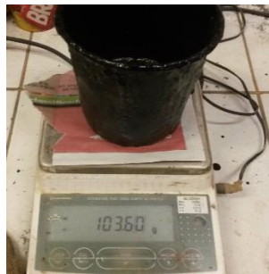
(b) Pesagem da emulsão asfáltica.
