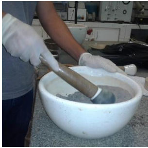
(a) Destorroamento do solo.
