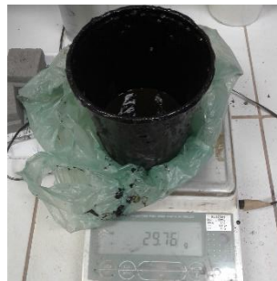
(b) Pesagem da emulsão asfáltica.
