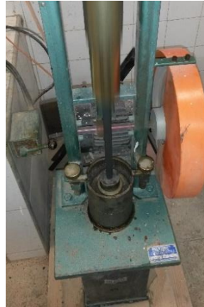
Figura 3.7 – Compactação da mistura solo-emulsão – ensaio Marshall.
