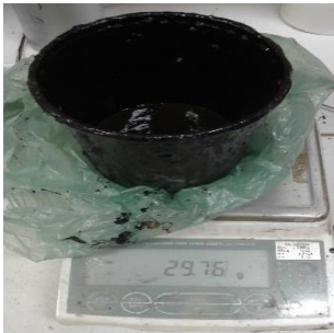
(d) Pesagem da emulsão asfáltica.
