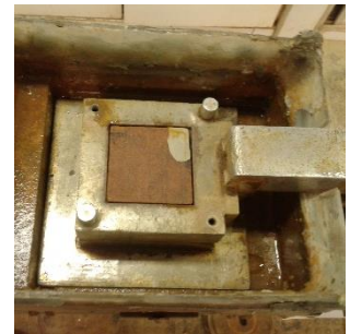
(f) Colocação da pedra porosa.
