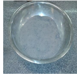
(c) Solo seco em estufa a 100°C esfriando.
