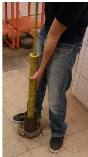
Figura 3.6 – Compactação da mistura solo-emulsão – ensaio Proctor.
