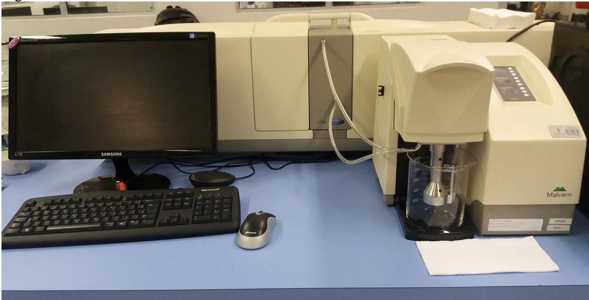
Figura 7- Analisador de Tamanho de Partícula a Laser
