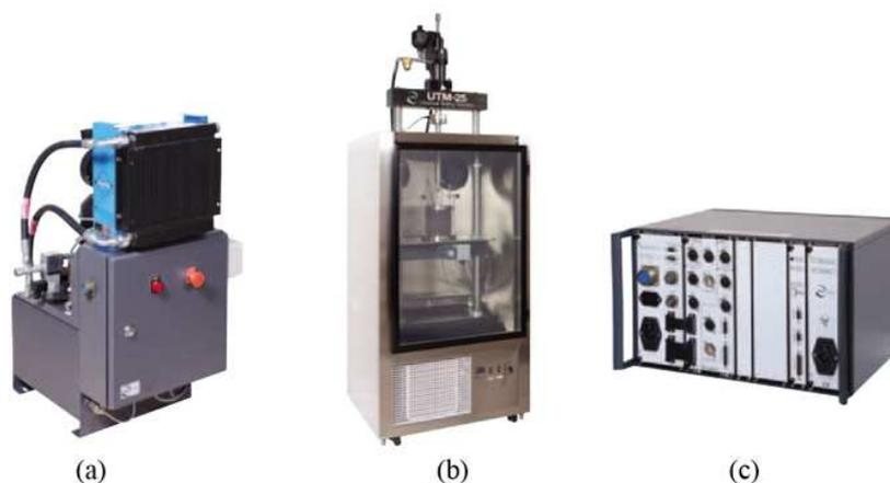
O IMACS trabalha como padrão de fábrica com oito canais de recebimento de dados (expansíveis até 32) e dois eixos de controle (expansíveis até oito). A programação dos ensaios e o tratamento de dados é realizada pelo pacote de *software* desenvolvido pela própria empresa, o UTS.
