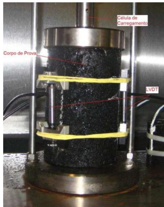
O procedimento descrito pela norma AASHTO TP62-03 (2003) para o ensaio de MD estabelece que o ensaio deve ser realizado a frequências que variam de 0,1Hz a 25Hz e em temperaturas dentro da faixa entre -10°C e 54,4°C. A norma ASTM 3497-79 (2003) estabelece apenas três temperaturas de ensaio (5°C, 25°C e 40°C) e três frequências de carregamento (1Hz, 4Hz e 16Hz).
