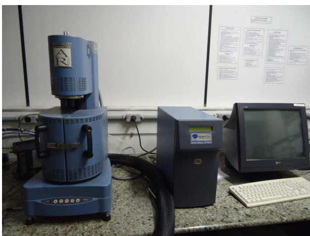
(a) Equipamento DSR
