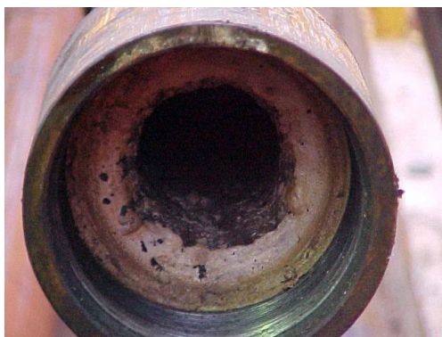
Figura 6 – Coluna de produção parcialmente obstruída por sulfato de bário.
