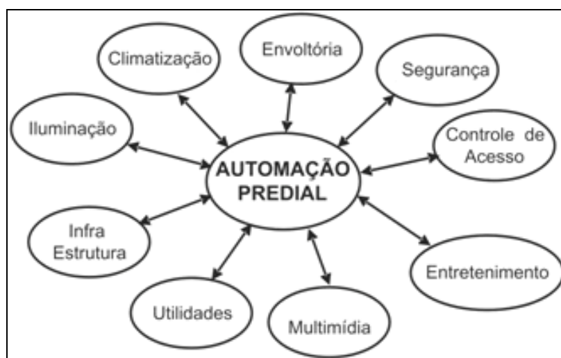
Figura 7 – Subsistemas prediais que podem ser automatizados
