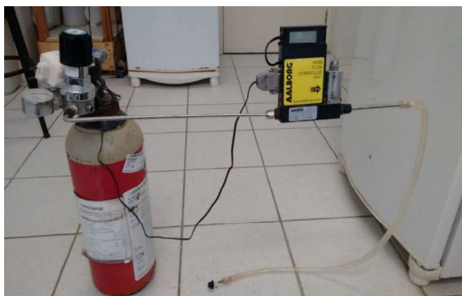
Figura 5 – Medidor de fluxo mássico utilizado na microaeração.
