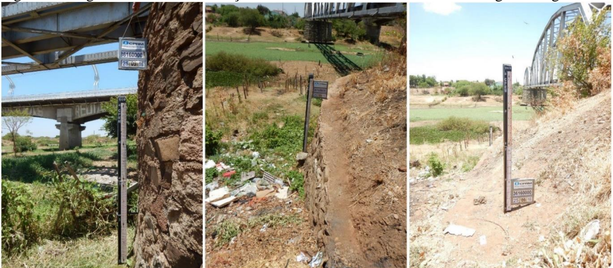
Figura 7 - Réguas linimétricas na seção de monitoramento hidrosedimentológico de Iguatu-Ce
