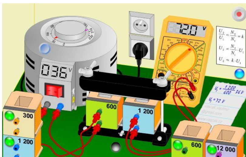
Figura 20: Tela inicial da simulação: Transformador.
