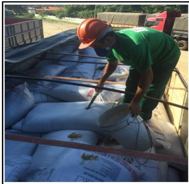
Figura 2 - Coleta representativa de amostra da farinha de carne e ossos, como matéria-prima ensacada (Fonte: Próprio Autor).
