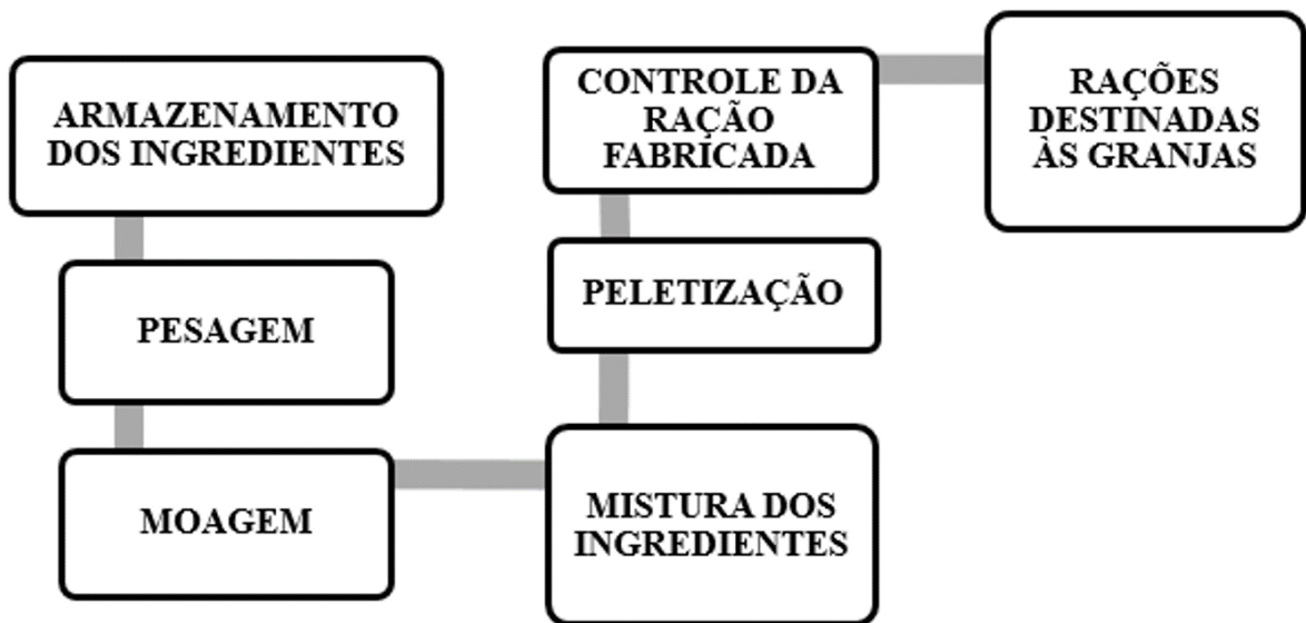
Figura 5. Fluxograma contendo as etapas para o efetivo controle de qualidade (Fonte: Adaptado do Manual BPF – Integral Agroindustrial (2015).
