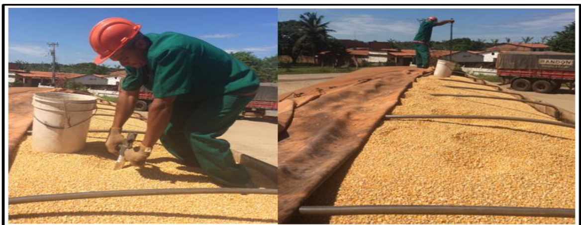
Figura 1 - Coleta representativa de amostras de milho grão em caminhão graneleiro (Fonte: Próprio Autor).
