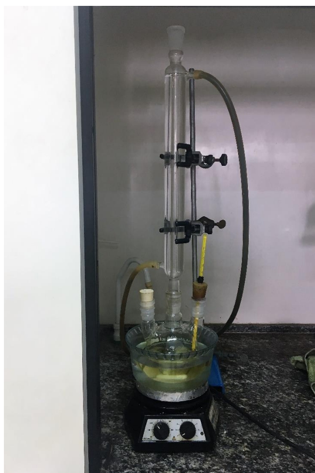
Figura 4: Processo de transesterificação do óleo de soja.
