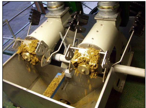
Figura 23 – Separador de esterco
