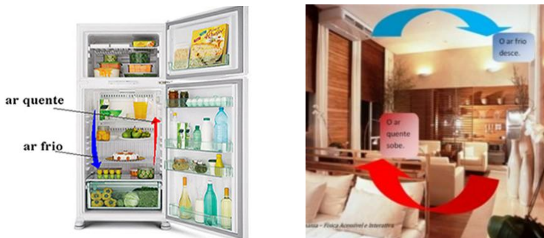
Figura 15: Convecção térmica na geladeira (à esquerda) e na sala com ar condicionado (à direita)
