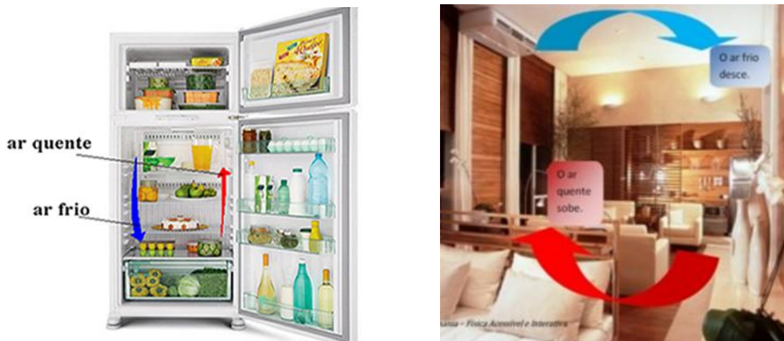
Figura 5: Convecção térmica na geladeira (à esquerda) e na sala com ar condicionado (à direita)
