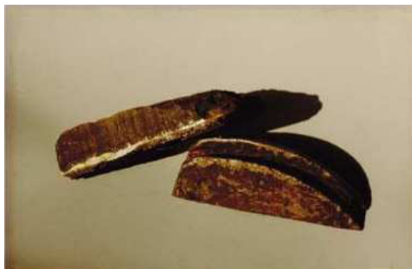
Figura 7 – Corrosão gráfrica em componente de bomba centrífuga de ferro fundido: parte escura, área corroída, devido à grafite.
