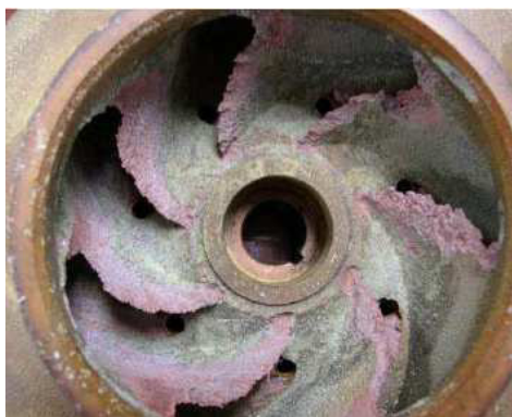
Figura 8 – Aparência de um rotor de uma bomba submetido à erosão-corrosão.
