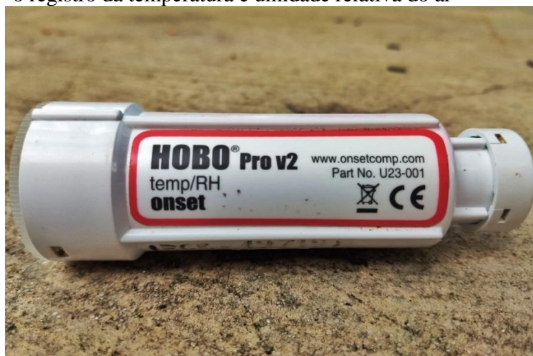
Figura 8 – Miniestação meteorológica utilizada para realizar o registro da temperatura e umidade relativa do ar
