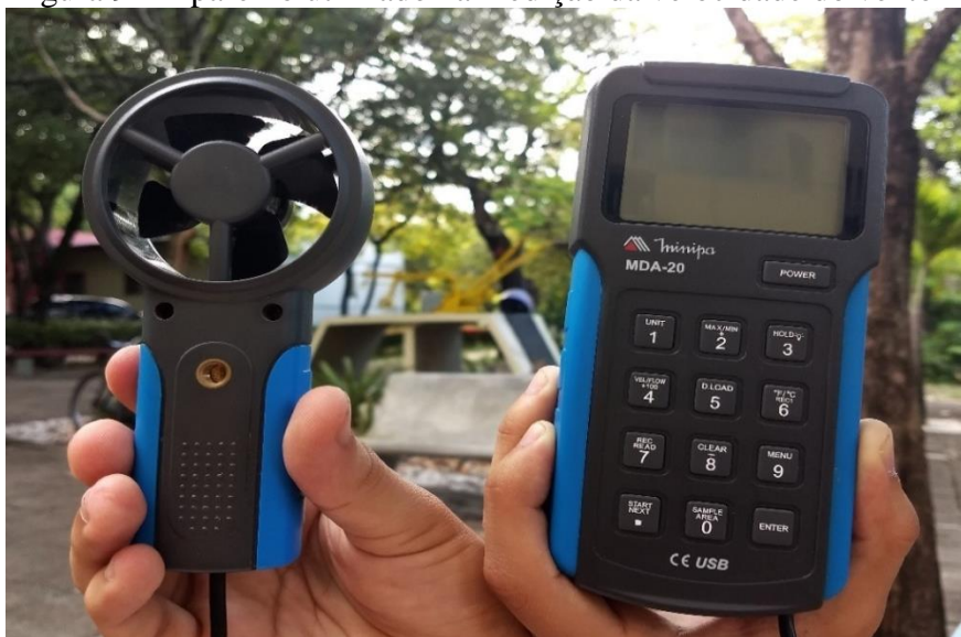
Figura 9 – Aparelho utilizado na medição da velocidade do vento
