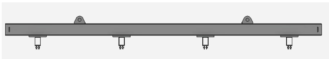
Figura 14 – Vista lateral da barra de carga (Fonte: Autor)
