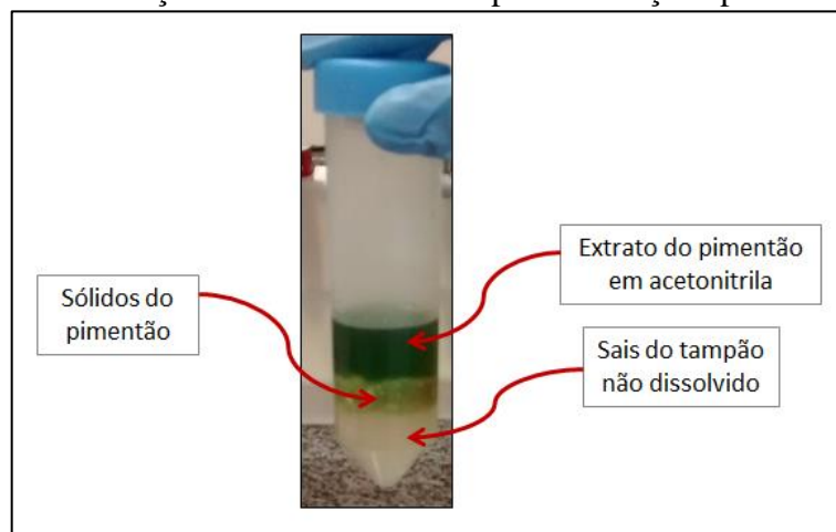
Figura 3.6 – Formação das três fases na etapa de extração após centrifugação.
