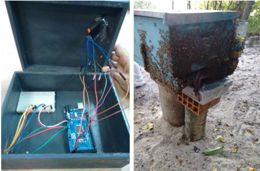
Figura 2 – Primeiro protótipo do nó sensor em detalhe e implantado em uma colmeia.
