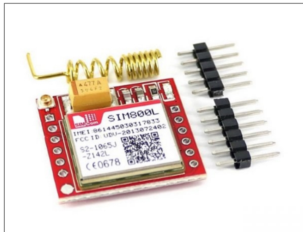
Figura 5 – Módulo SIM800L em detalhe.
