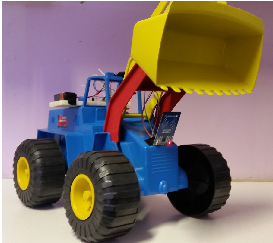
Figura 15 – Protótipo de pá-carregadeira equipado com RFID
