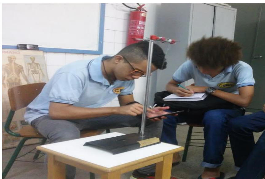
Foto 8 – Alunos do 1º Ano registrado o tempo de oscilações do pêndulo simples para calcular a frequência e o período.
