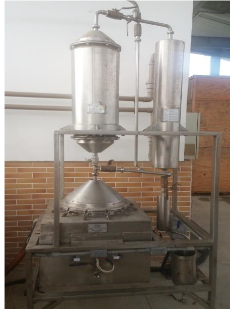
Figura 10 - Torre de destilação
