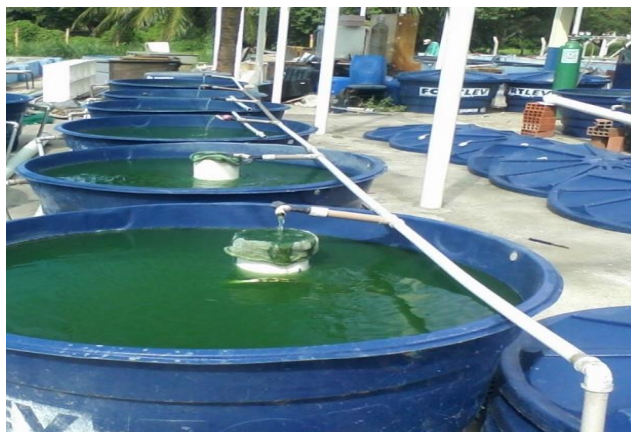
Figura 1 - Sistema de produção da microalga Arthrospira platensis na Estação de Aquicultura Prof. Raimundo Saraiva da Costa do Departamento de Engenharia de Pesca da Universidade Federal do Ceará.
