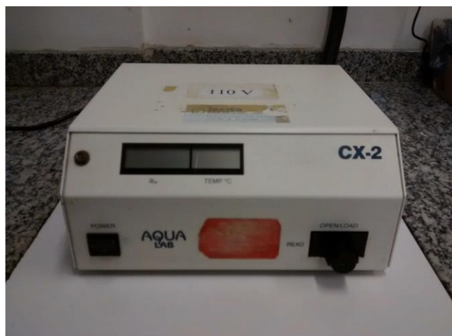
Figura 6: Equipamento utilizado para determinação da A_w .
