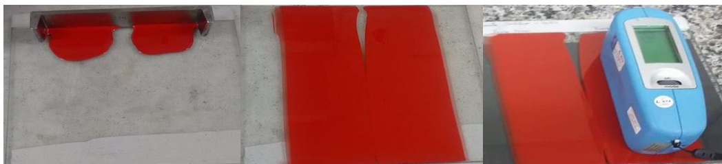
Figura 11 - Ensaio de medição de brilho do esmalte
