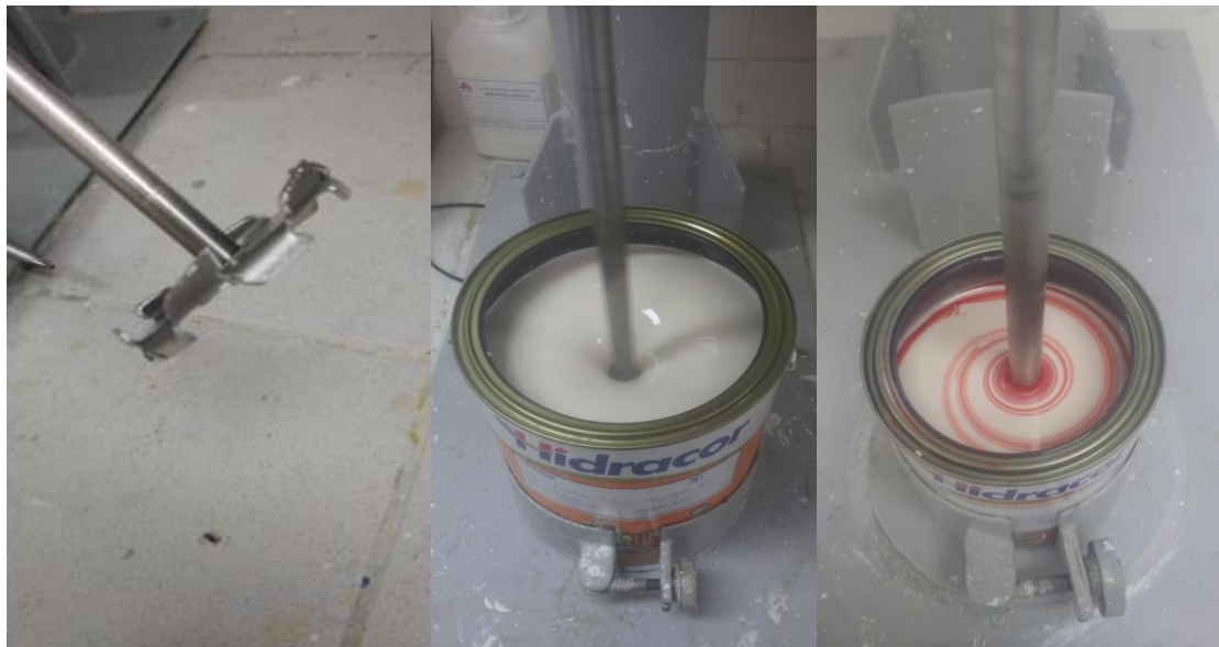
Figura 14 - Sistema de dispersão e mistura do esmalte sintético
