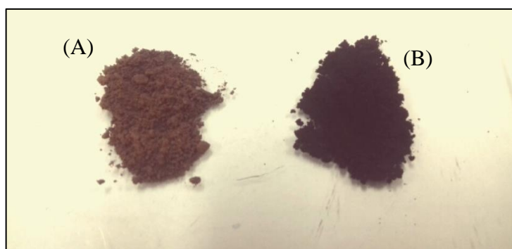
Figura 13: (A) Lignina recuperada a partir do licor negro; (B) Lignina lavada com hexano.
