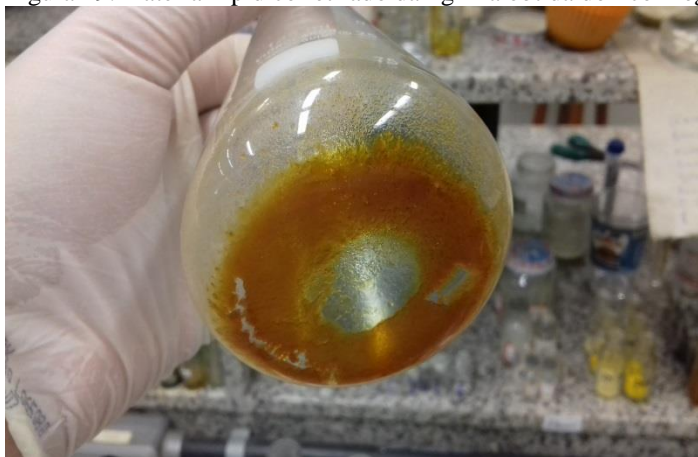
Figura 19: material lipídico retirado da lignina obtida do licor negro
