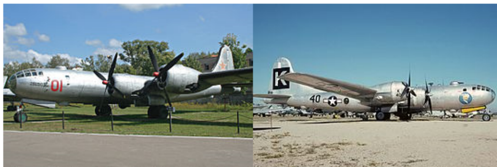
Figura 2 - O Tupolev Tu-4, à esquerda, foi desenvolvido pelos soviéticos a partir da engenharia reversa do Boeing B-29 Superfortress dos EUA, à direita.
