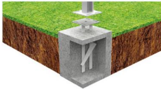
Figura 29 - Exemplo de fundação em concreto.
