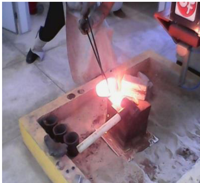
Figura 28 — Vazamento do Aço Alto Mn para o molde de areia.
