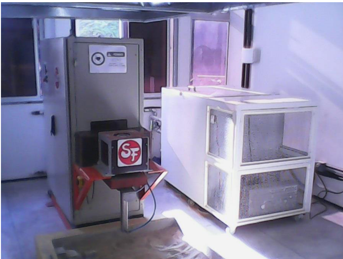
Figura 18 — Forno de Indução do Laboratório de Fundição (LAF-UFC).
