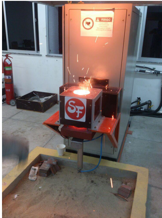
Figura 23 — Início da fusão da carga metálica.
