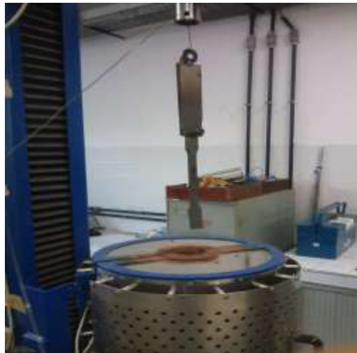
Figura 52 - Esquema do ensaio de recozimento contínuo em laboratório.
