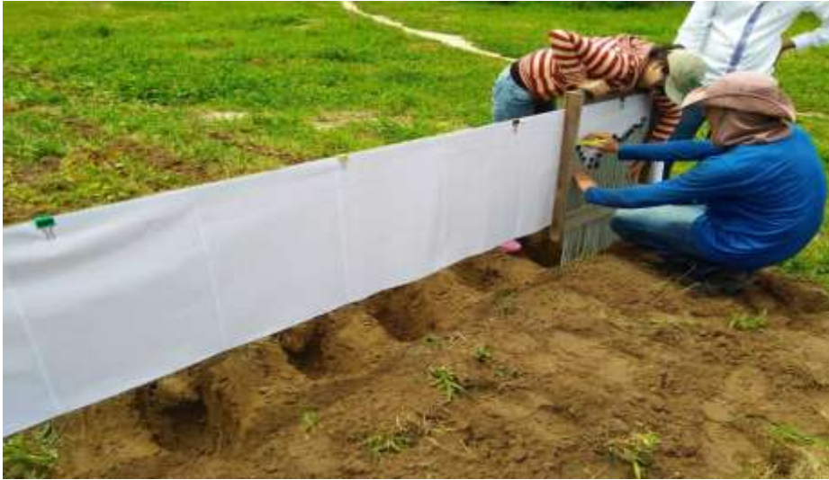
Figura 11 - Levantamento do perfil da superfície natural e de fundo, após passada do conjunto.
