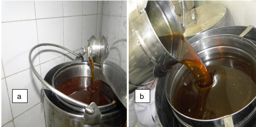
Figura 23 – Mel extraído da centrífuga, passando pela primeira peneira, para o balde de aço inox (a), mel passando por uma segunda peneira, de malha mais fina, do balde para o decantador (b).
