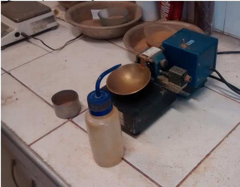
Figura 12 - Aparelho de Casagrande utilizado em laboratório.
