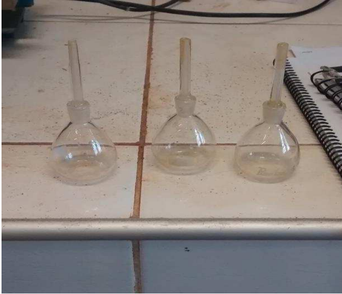
Figura 15 - Picnômetros utilizados nos ensaios laboratoriais.
