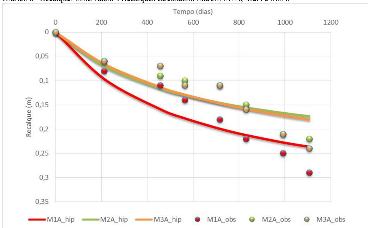
Gráfico 8– Recalques observados x Recalques calculados: Marcos M1A, M2A e M3A.
