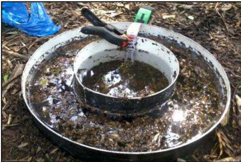
Figura 5 – Ensaio de infiltração com duplo anel.
