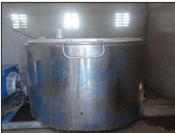
Figura 58 – Tanque em local fechado sem azulejos
