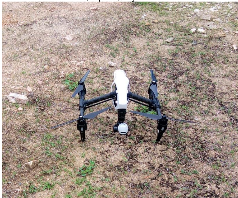
Figura 11 - VANT utilizado no levantamento (Inspire 1), cujas dimensões são 48 cm × 45 cm × 30 cm
