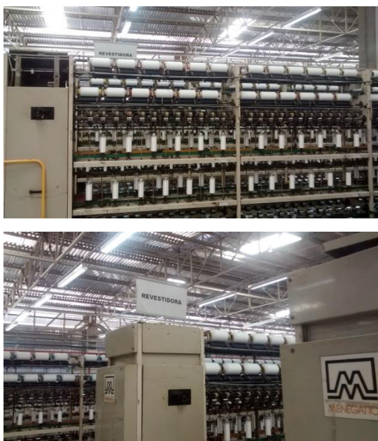
Figura 5. Processo de revestimento do fio com poliamida.
