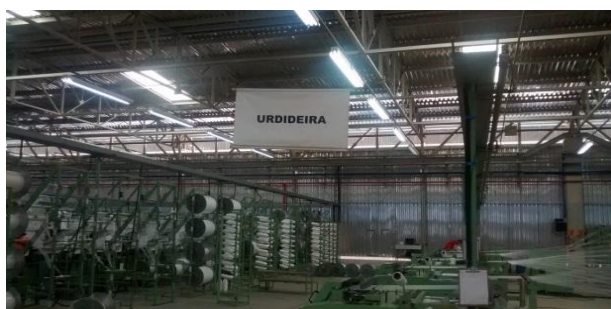
Figura 6. Processo de Urdimento do fio elástico.
