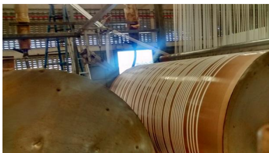
Figura 13. Processo de secagem da fita elástica.
