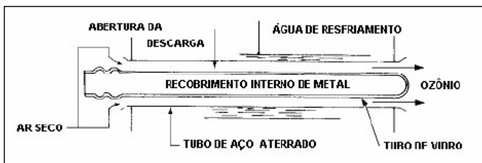
Figura 1 - Esquema da célula geradora de ozônio
