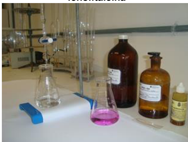
Figura 7- determinação da AP a usando fenolftaleína
