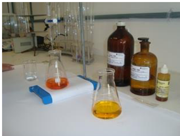
Figura 8 - determinação da AT usando o alaranjado de metila
