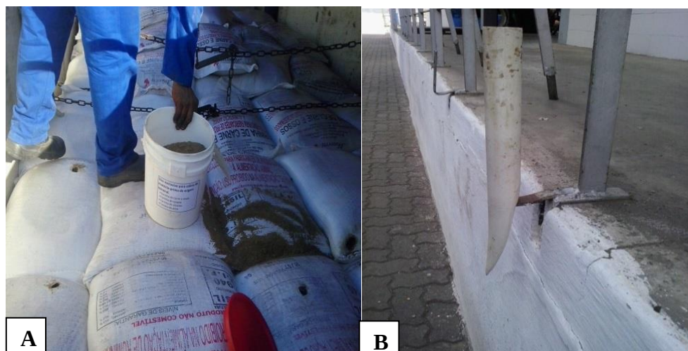
Figura 3 - Coleta de amostra de produto ensacado (A) e calador simples (B)
