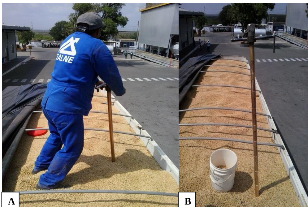
Figura 2 - Coleta de amostra de produto a granel (A) e calador manual (B)
