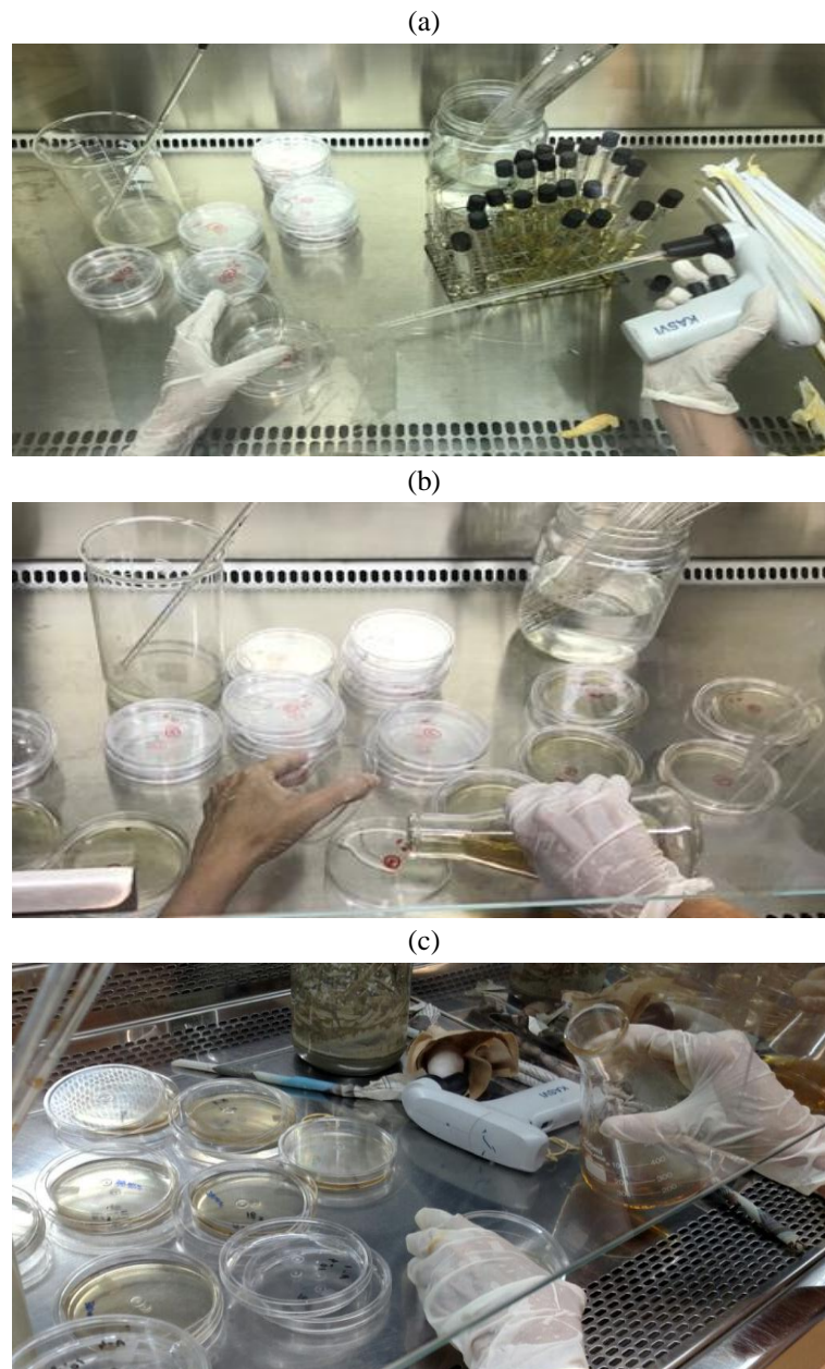
Figura 3.6 - Detalhes dos procedimentos para as análises microbiológicas. (a) Placa inoculada; (b) Colocação meio de ágar padrão para contagem PCA; (c) Colocação meio de ágar padrão para contagem PCA. Fortaleza, Ceará. 2017.
