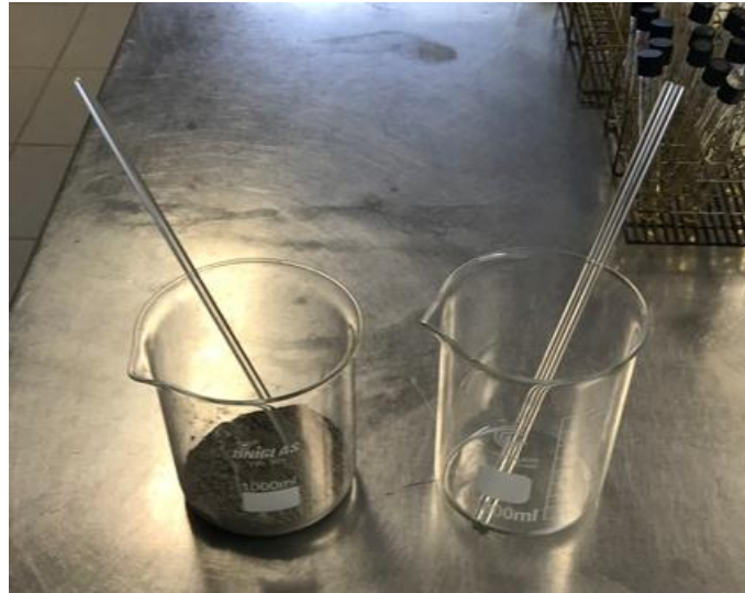
Figura 3.1 - Procedimentos para as análises microbiológicas. Becker um com cimento/AACI e outro vazio. Os dois receberam 100mL de esgoto bruto, para serem avaliados no tempo 30 min. Fortaleza, Ceará. 2017.
