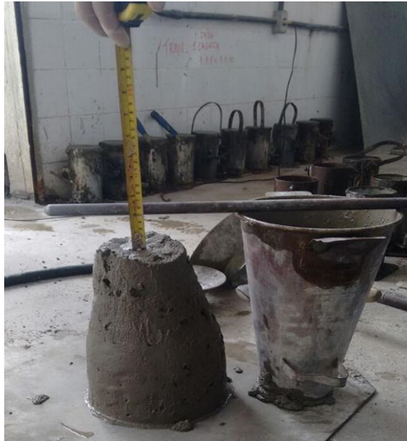
Figura 3.13 - Ensaio de abatimento de tronco de cone ou slump test. 2017. Laboratório de Materiais da UFC. Fortaleza, Ceará. 2017.
