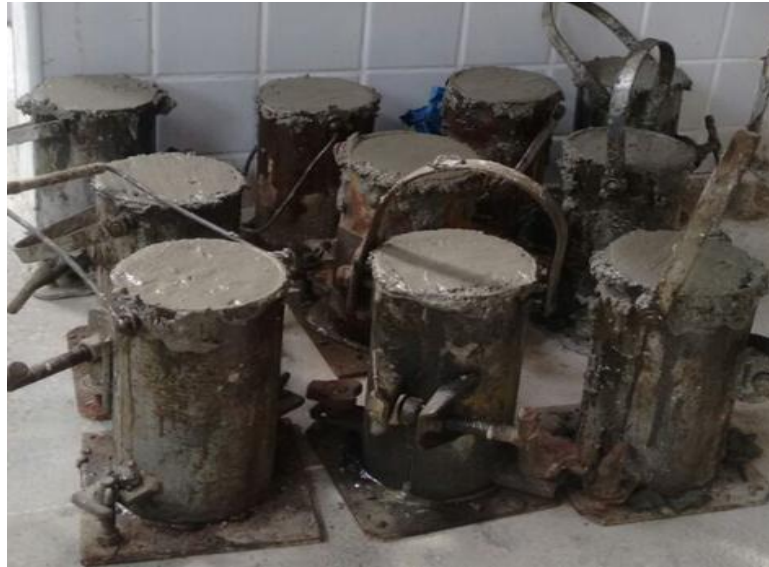
Figura 3.14 - Moldagem de três grupos de dez corpos de prova. Laboratório de Materiais da UFC. Fortaleza, Ceará. 2017.
