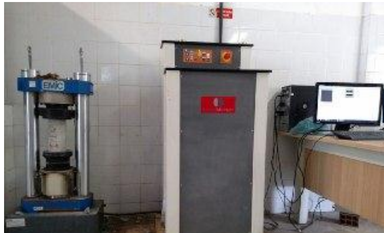
Figura 3.15 - Equipamentos utilizados no ensaio de rompimento à compressão. Laboratório de Materiais da UFC. Fortaleza, Ceará. 2017.
