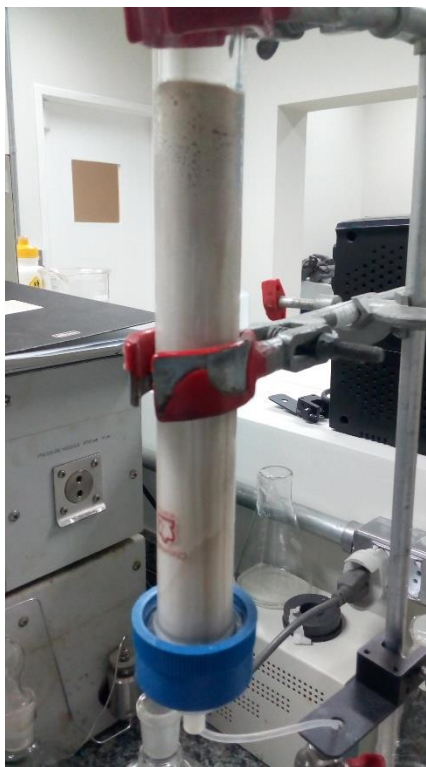
Figura 10 – Aparato experimental utilizado para realização da cromatografia líquida.
