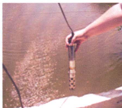
Figura 5: Sonda Horiba utilizada para coleta de parâmetros físico-químicos da água.
