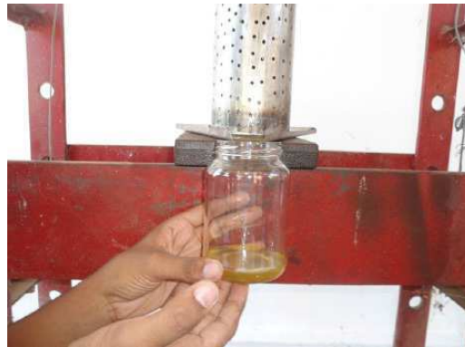
Figura 8 – Extração do óleo de gergelim utilizando filtro prensa
