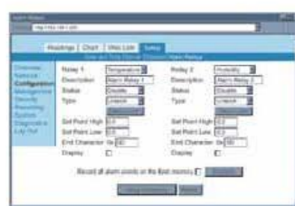
Configuração de relé de alarme através do servidor Web incorporado
